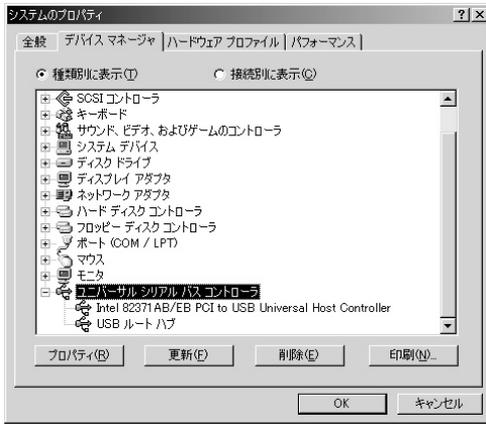
これはUSBインターフェイスの正常な動作状況です。USBデバイスアイコンに「I」マークが表示されていたり、または「ユニバーサルシリアルバスコントローラ」のデバイスがなにも見つからない場合、マザーボードのBIOSをアップグレードしたり、BIOS設定を確認してください。一部の機種ではデフォルトの状態ではUSBポートの使用が不可に設定されています。また「ユニバーサルシリアルバスコントローラ」のベンダー名、デバイス名はマザーボードによって異なることがあります。インテル社以外の記述の際もありませんので、本体(マザーボード)メーカーにサポートしてもらってください。
