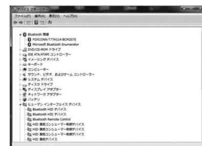
②デバイスマネージャーの中に、「Bluetooth無線」の項目がありますので、その中のBluetoothデバイスドライバの欄を右クリックし、「プロパティ」を開きます。使用されているパソコンによって名称が異なります。
