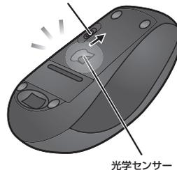
※マウスを動かしている際、カーソルの動きがスムーズでなくなったり光学センサーが点灯しなくなったら、電池を交換してください。
