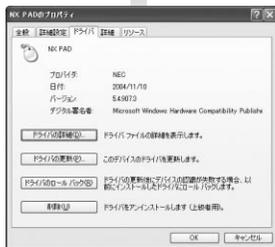
③ドライバのタブをクリックし、続けて「ドライバの更新」のボタンをクリックします。
