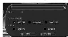
本製品のDPI切り替え機能はダイナミックで柔軟な切り替え機能を備えているので、ゲームのプレイヤーはDPIをいつでも変更できます。DPIレベルはお使いの製品の種類により異なります。DPIモードを直接選択するには、「SET DPI MODE(DPIモードの設定)」グループから設定を選択するか、「DPI UP(DPIを上げる)」または「DPI DOWN(DPIを下げる)」を選択して、巡回式のDPIスクローリング・モードを使用します。
