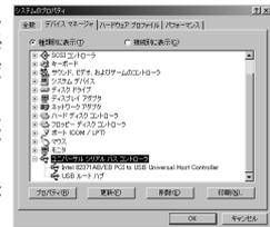
USBデバイスアイコンに「！」マークが表示されていたり、もしくは「ユニバーサルシリアルバスコントローラ」のデバイスがなにも見つからない場合、マザーボードのBIOSのアップグレードや、BIOSの設定をご確認ください。初期状態ではUSBポートの使用が不可に設定されている機種もあります。
