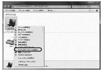
④ 「いいえ」を選択し、「コンピューター上で…」が「Windows Updateから…」を選択し、「変更の保存」をクリックして完了です。その後、USB機器の接続を行ってください。
