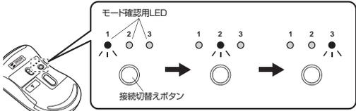
2.接続切替ボタンを長押ししてください。モード確認用LEDが点滅します。
