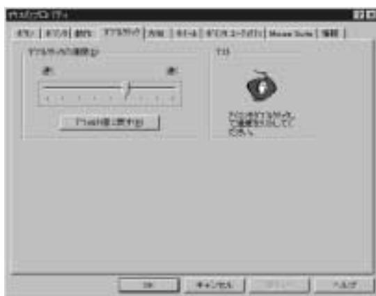
ダブルクリックのスピードを調節する場合、ダブルクリックの速度(D)内のスライダーをクリックアンドドラッグで左右に移動させてください。左側に移動させると速度は遅くなり、右側に移動させると速くなります。マウス操作に慣れていない方は、バーを左側に移動させると、ダブルクリックの速度は遅くなるので、使い易くなります。
