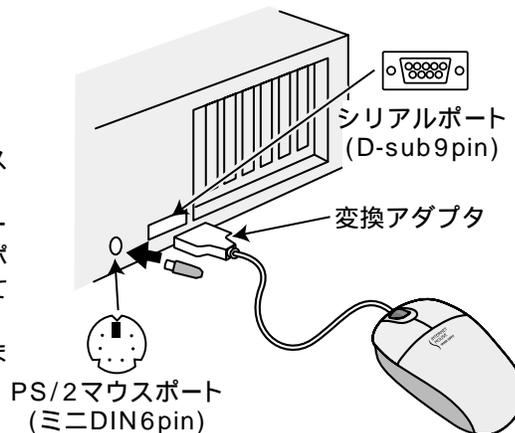
一部の富士通FMVノート、IBM ThinkPadなどポインティングデバイス内蔵のノートパソコン(排他制御機能のないタイプ)及びUSBキーボードにPS/2マウスが接続できるデスクトップパソコンにはシリアルポート接続により対応しています。
