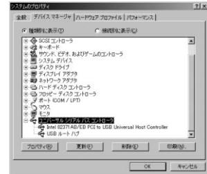
これはUSBインターフェイスの正常な動作状況です。USBデバイスアイコンに「!」マークが表示されていたり、または「ユニバーサルシリアルバスコントローラ」のデバイスがなにも見つからない場合、マザーボードのBIOSをアップグレードしたり、BIOS設定を確認してください。
