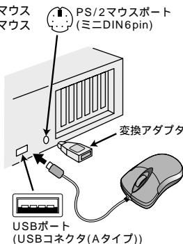
3.付属の変換アダプタを使用して、本製品をコンピュータのPS/2マウスポートに接続します。
