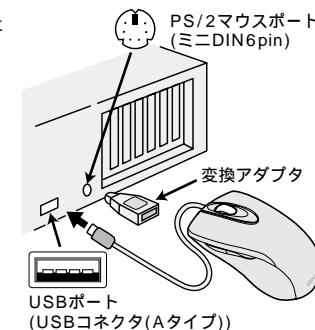
一部の富士通FMVノート、IBM ThinkPadなどポイントティングデバイス内蔵の一部のノートパソコン(排他制御機能のないタイプ)及びNEC PC98-NXデスクトップパソコンなど(USBキーボードにPS/2マウスポートが付いているパソコン)には、USBポート接続により対応しています。
