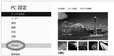
5.右に表示されるメニューの「デバイスの追加」をクリック、またはタップし、「Bluetooth Mouse」が見つかったら、選択してペアリングを完了させます。※1
