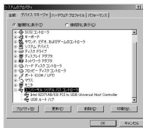
これはUSBインターフェースの正常な動作状況です。USBデバイスアイコンに「！」マークが表示されていたり、または「ユニバーサルシリアルバスコントローラ」のデバイスがなにも見つからない場合、マザーボードのBIOSをアップグレードしたり、BIOS設定を確認してください。一部の機種ではデフォルトの状態ではUSBポートの使用が不可に設定されています。また「ユニバーサルシリアルバスコントローラ」のベンダー名、デバイス名はマザーボードによって異なることがあります。インテル社以外の記述の際もありますので、本体(マザーボード)メーカーにサポートしてもらってください。
