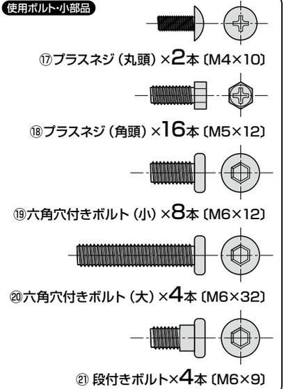
**1 サイドフレームとサイドカバーにつまみボルトと段付きボルトを取付けます。**
