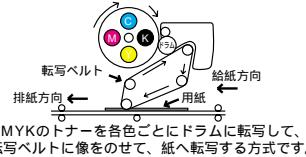
CMYKのトナーを各色ごとにドラムに転写して、転写ベルトに像をのせて、紙へ転写する方式です。
