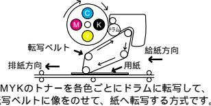
CMYKのトナーを各色ごとにドラムに転写して、転写ベルトに像をのせて、紙へ転写する方式です。
