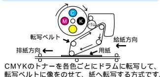
CMYKのトナーを各色ごとにドラムに転写して、転写ベルトに像をのせて、紙へ転写する方式です。
