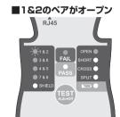
1&2のペアがオープン(断 線)になっている場合、右側 の"OPEN"のLEDが点灯 し、左側の1&2のLEDが点 滅します。
