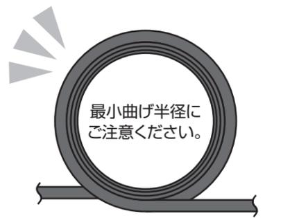
**4. 光ファイバケーブルの束線および固定時にご確認ください。**
