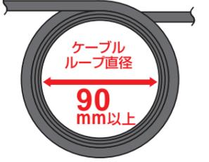
**9. 機器にコネクタを接続した状態での曲げ半径(距離)について。**
