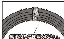
光ファイバケーブルを束ねる時は固定する時に、HDMIコネクタやDisplayPortコネクタの結線部を持って固定します。コネクタの結線部は強く引っ張らないように取扱います。
