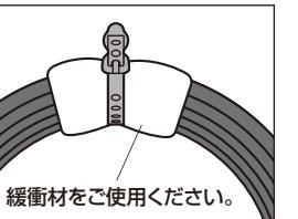
保管時、非使用時に光ファイバケーブルを束線あるいは固定する場合には、DisplayPortコネクタと結線部を併せて固定します。コネクタの結線部は強く引っ張らないように取り扱います。
