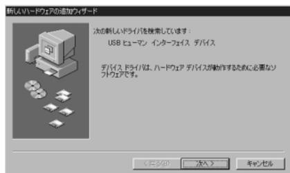
USBポートにUSBジョイスティックを差し込んで下さい。「新しいハードウェアの追加ウィザード」でドライバ検索の画面になります。次へ>をクリックします。
