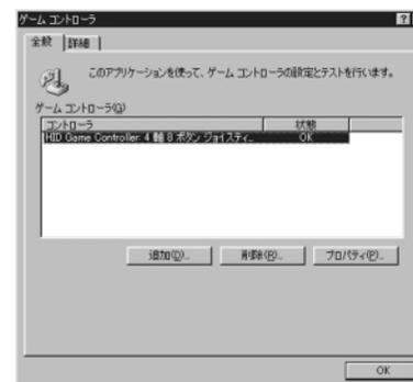
USBジョイスティックの設定及び調整は、Windows®98でコントロールパネルの「ゲームコントローラ」の調整で行います。コントロールパネルの「ゲームコントローラ」をダブルクリックします。HID Game Controller 4軸8ボタンジョイスティック、状態がOKになっていることを確認して「プロパティ」をクリックして下さい。
