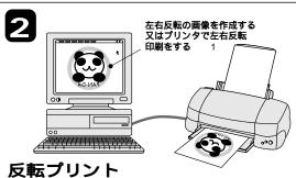
インクジェットプリンタで転写シートの表面に反転 プリントします。用紙設定では用紙の種類を「⊤シ ャツ転写紙」または普通紙にしてください。
