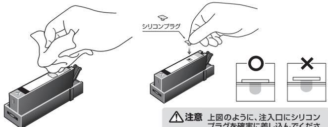
**注意** 上図のように、注入口にシリコンプラグを確実に差し込んでください。インクが供給口から流れ出して止まらない場合があります。
