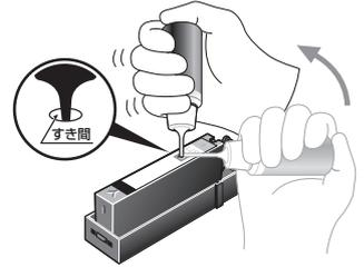
2. インクが注入口からあふれ出たら、一旦注入を止めてインクがスポンジに吸収される時間(約30秒)待って、再度インクをゆっくりと注入してください。
