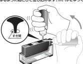
2.インクが注入口からあふれ出たら、一旦注入を止めてインクがスポンジに吸収される時間(約10~15秒)待って、再度インクをゆっくりと注入してください。
