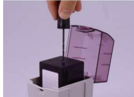
1.ドリルで空気穴の栓を抜きます。
