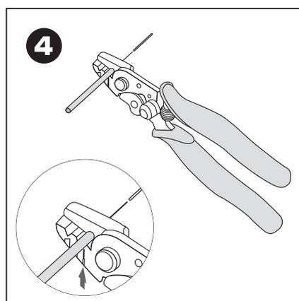
250µmのアクリル(UV樹脂)の外皮をむき取ります。
