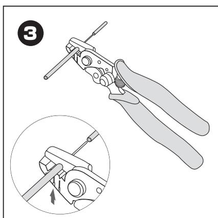
900µmのバッファ外皮(ナイロン被覆)をむき取ります。
