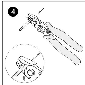
250µmのアクリル(UV樹脂)外皮むき取り
