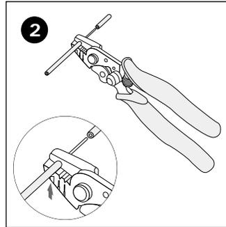
2mm ~ 3mm径の絶縁の外皮むき取り
