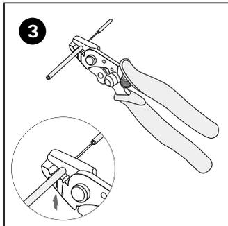
900µmのパuffa外皮(ナイロン被覆)むき取り
