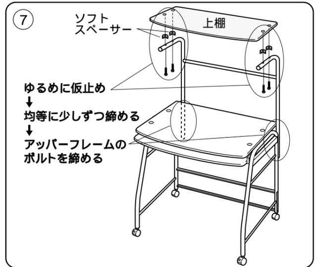
1本ずつボルトを締めると、天板・上棚にねじれが生じ、**ガラスが割れる恐れがあります**ので、必ず守ってください。
