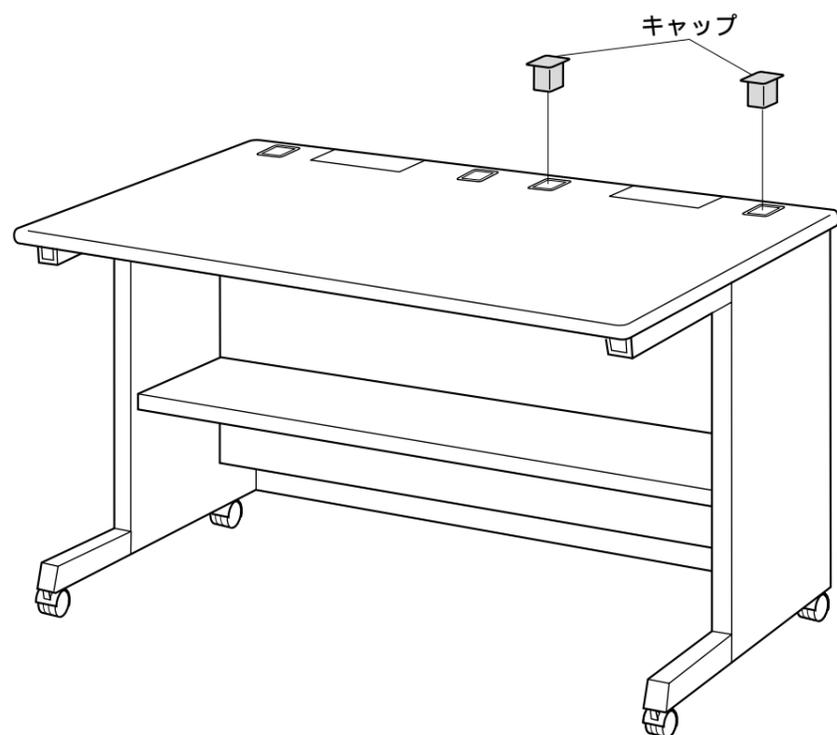
3 キャップを取ったテーブルトップの穴にアームを差し込みボルトBで取り付け、バックパネルを取り付けます。ただし、センターアームを取り付ける際は、リーンフォースメントを上ボルトでいっしょに取り付けます。
