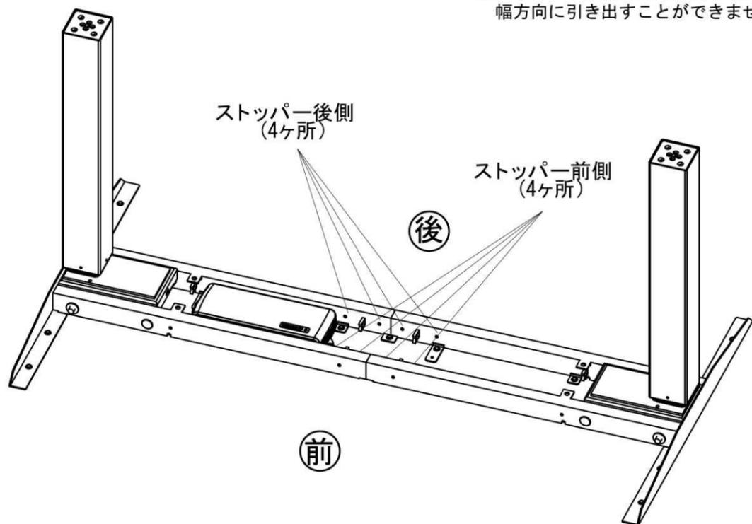
4 最初に昇降フレームの中心とテーブルトップをスクリュAで2ヶ所仮止めします。次に昇降フレームの両サイドを引き出し、テーブルトップ裏面のナットと昇降フレーム/天板取り付けブラケットの穴位置を合わせスクリュAで仮止めします。最後に仮止めしたスクリュAと③のストッパーを締め直します。
