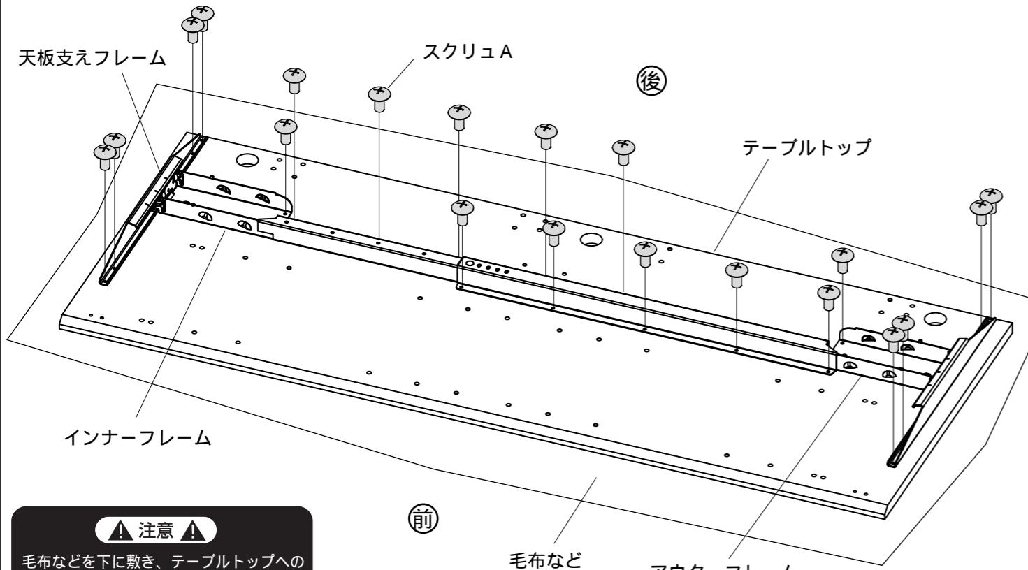
4 アウター、インナーフレームへ昇降フレームをセットし、クランプで固定します。
