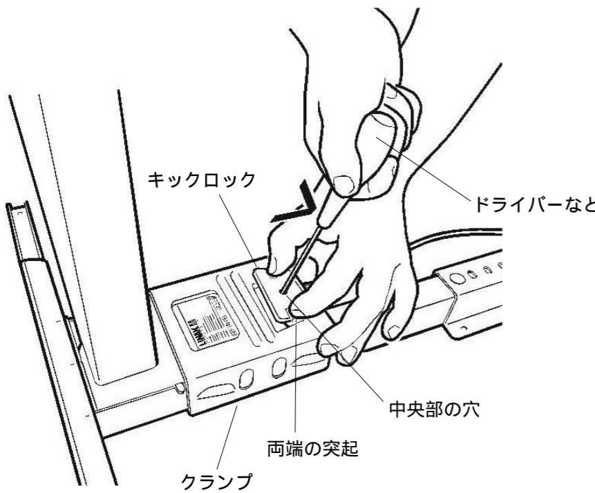
ドライバーの握り部などでクランプを昇降フレーム側へ押し込みます。
