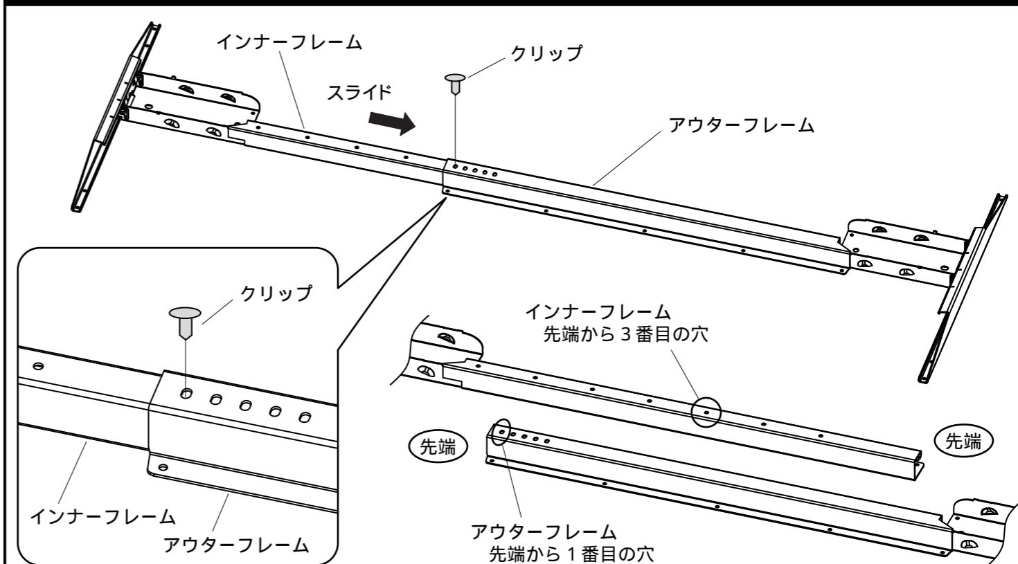
3 テーブルトップへ天板支えフレームとアウター、インナーフレームをスクリュAで仮止めし、
