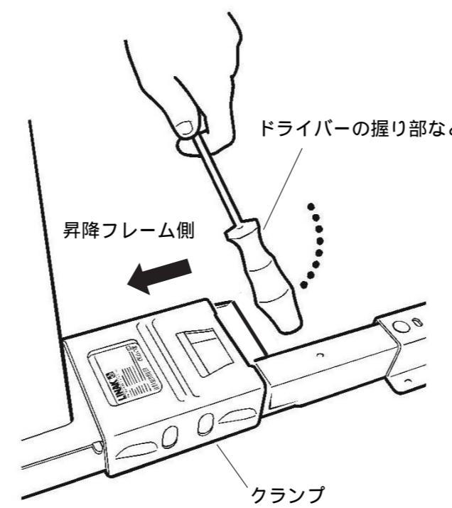
クランプ両側の突起にドライバーの先端などを差込み、外側へ押しながらクランプを取り外します。
