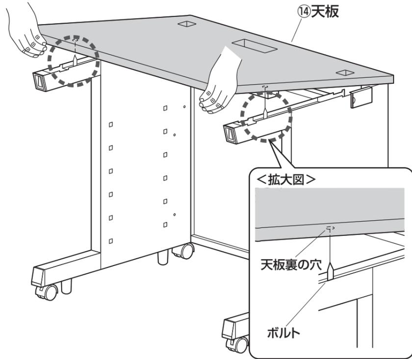
天板との間に隙間を設けて、ボルトを取付けます。
