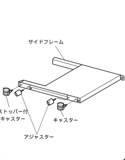
**2** サイドフレームの後側のナットにボルトをねじ込みます。ボルトは2~3mmの隙間をあけてください。
