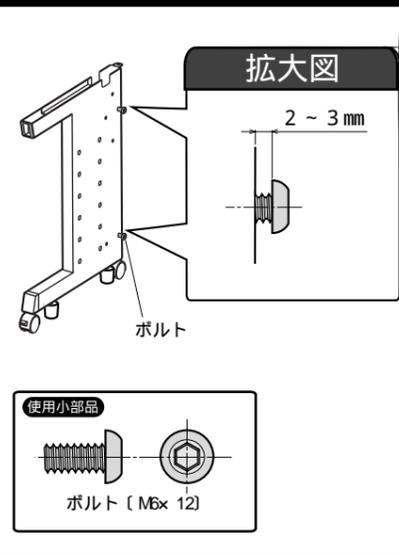
**3** バックフレームはだるま穴にボルトを差込み押し下げます。ボルトをゆるく締めます。
