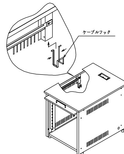
10 最後にパックパネルに蓋をボルトナット（M5）取り付け後、
