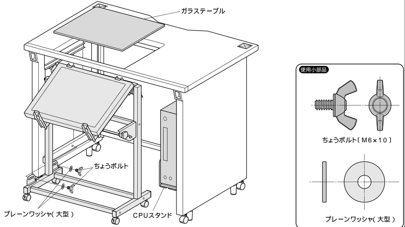
**11** キーボードテーブルを取り付けます。配線処理を済ませてバックパネルをボルトAで取り付けて完成です。
