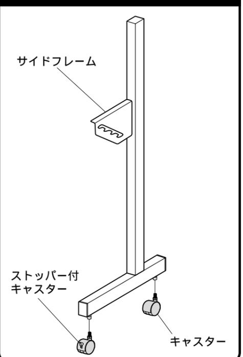
2 サイドフレーム(A)と(B)をフレーム(B)で連結します。その時アジャスターフレームも取り付けます。
