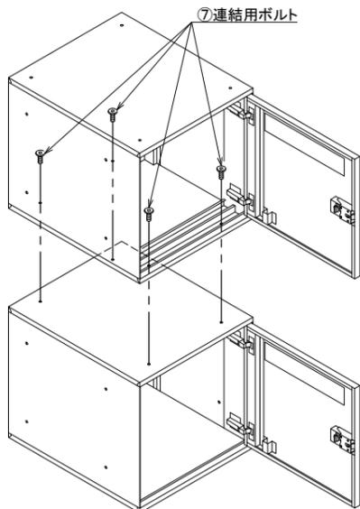
上側の製品の下段棚板を取り外し、上側の製品と下側の製品の角を合わせて、付属のボルトで取付けてください。
