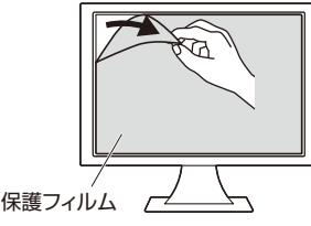
6 りけい紙をはがしたフィルムアタッチメントの接着部をディスプレイの筐体(枠)部分へ、非接着部がフィルターへかぶさるように左右2ヶ所ずつ図の位置に貼付けて取付け完了です。
