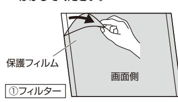
4 フィルター裏面をディスプレイの画面にていねいに押しつけてセットしてください。
