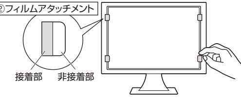
7 うまく固定できない場合、大型サイズのディスプレイへ取付ける場合、ノートパソコンの開閉時にフィルターがずれる場合は○部分へフィルムアタッチメントを取付けてください。
