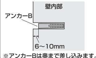
④ タッピングボルトAで壁面用ブラケットを固定します。
