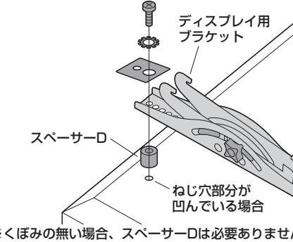
※付属のボルトが最後まで締まらない、またボルトが少ししか回っていないなど、ボルトが合わない場合は、強度に十分ご注意の上、市販の適切なサイズのボルトをご用意ください。
