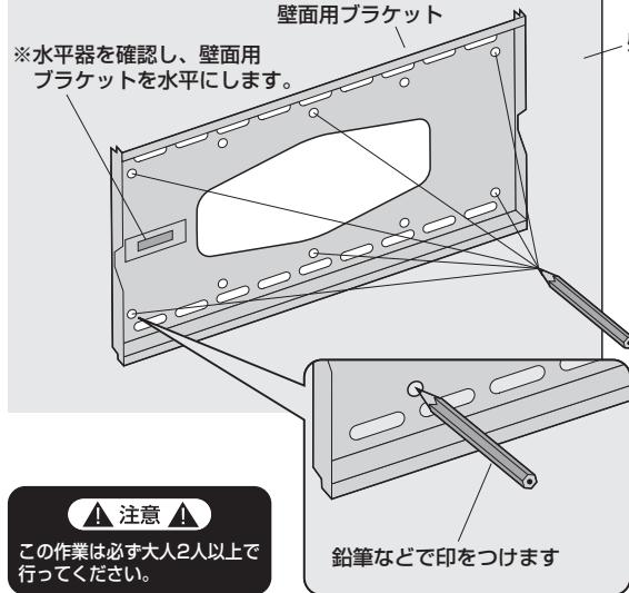
② ドリルを使い壁に印をつけた6カ所に直径9.5mm、深さ約55mm~60mmの下穴をあけます。
