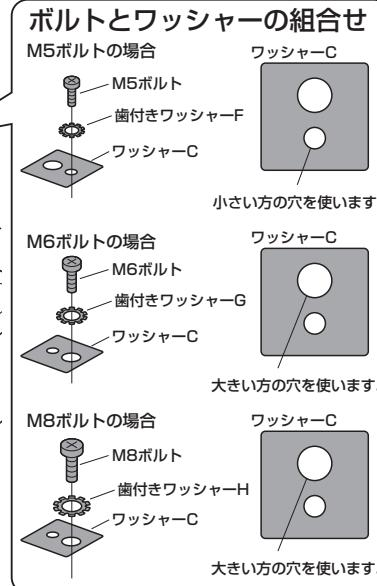
**！注意！** ボルトが長すぎるとディスプレイを破損する場合があります。また、ボルトが短すぎるとディスプレイがしっかりと固定できず脱落する恐れがあります。取付けに適したボルトの長さは各ディスプレイによって異なります。
