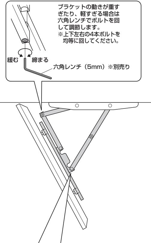
ブラケットの動きが重すぎたり、軽すぎる場合は六角レンチでボルトを回して調節します。
