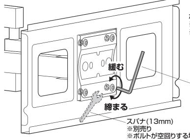
ボルトを緩めてディスプレイ取付け部を水平にします。
