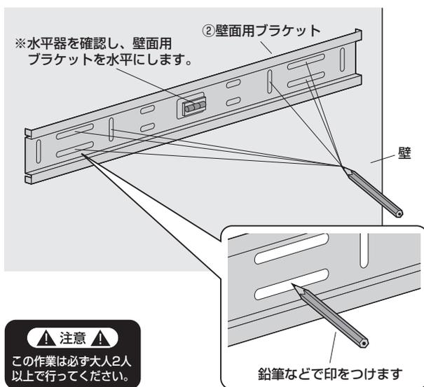
②ドリルを使い壁に印をつけた6ヶ所に直径4mm、深さ約20mm~30mmの下穴をあけます。
