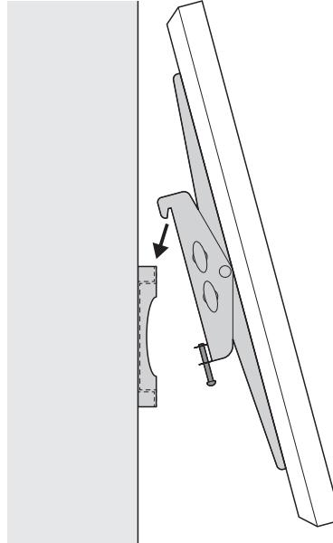
③ディスプレイ用ブラケットのボルトを締め付けます。
