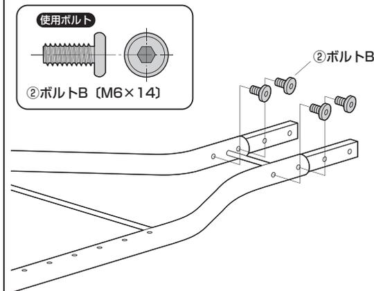
※同様にもう一方の下フレームにも連結金具を取付けます。
