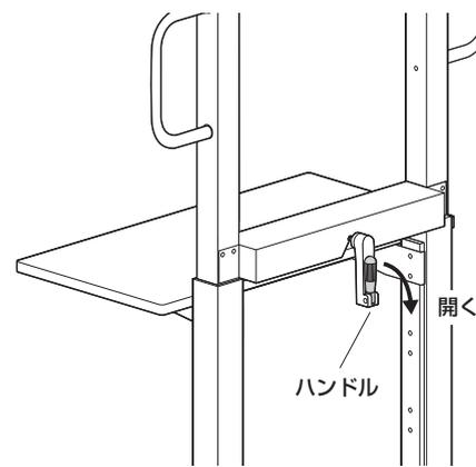
②ハンドルを回すとディスプレイの高さが調節できます。高さ調節後は逆の手順でハンドルを収納します。
