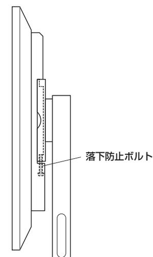
※同様にもう片方の落下防止ボルトも締め付けます。
