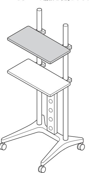
※ブラケットのボルトをゆるめて棚板の高さを調整してください。
