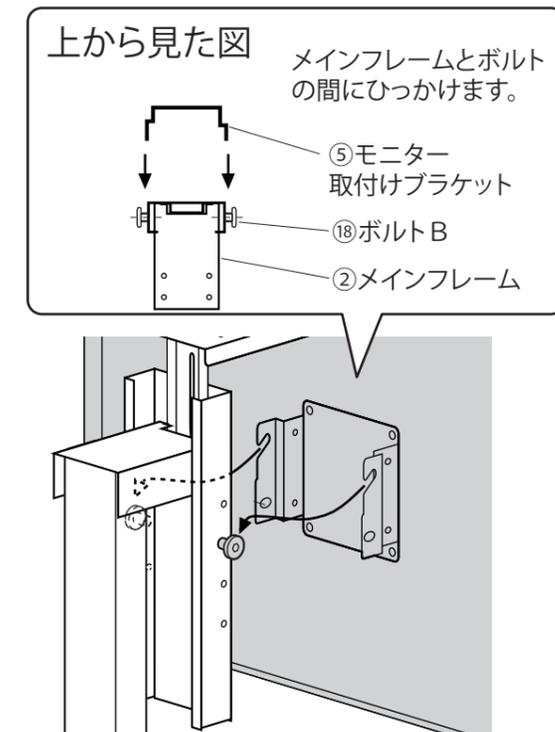
③ ボルト B を締付けて固定します。
