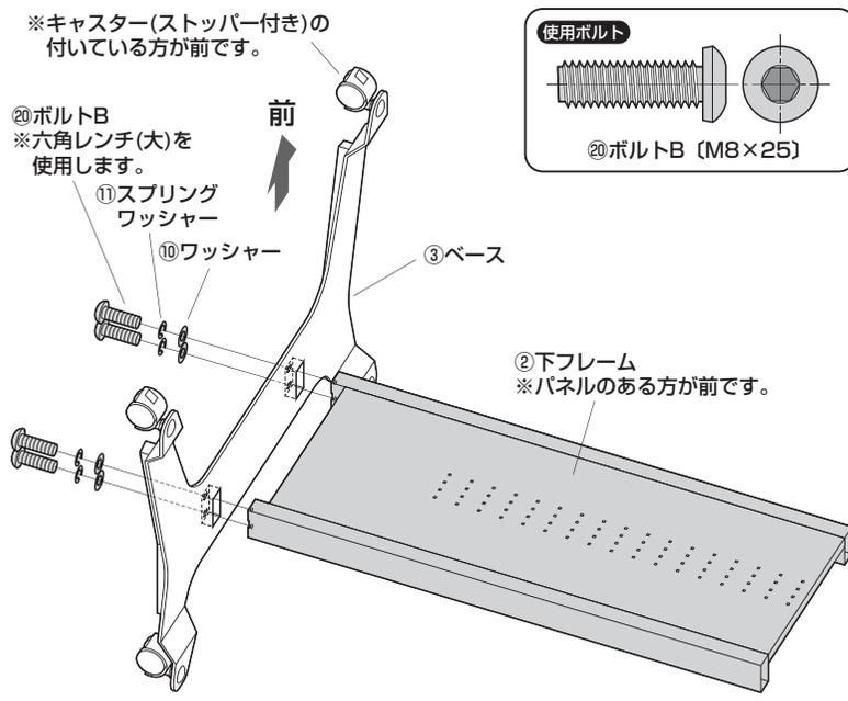
**3 下フレームを起し、上フレームを取付けます。**
