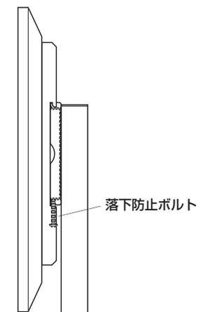
※両方のブラケットAの落下防止ボルトを締めます。
