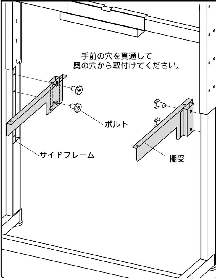
**2** 棚受に棚板をのせて、ボルトで取付けて完成です。
