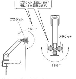
ブラケットの動きが軽すぎる場合、 ボルトキャップをはずし、スパナで ボルトを締め付けて調節します。
